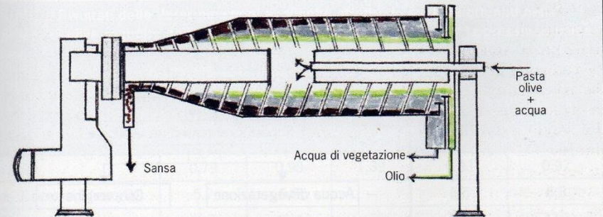
Figura 9.1 – Schema di funzionamento del decanter centrifugo a 3 fasi (3 uscite).
